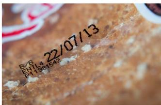
由于封口件是提供保质期信息的唯一空间，因此萨斯科需要大型封口件满足其喷码要求。遗憾的是，大型封口件仍然限制了他们可喷印的内容。转而使用伟迪捷 CIJ 解决方案后，他们可直接在每个包装袋上进行喷印，并可喷印包括保质期、批号和生产信息的两行编码。在包装袋上喷印为他们提供了灵活性，可喷印诸如促销信息等更多内容。他们还可在包装袋上的任何位置灵活喷码，而非仅限于在包装袋的封口件上进行喷码。
